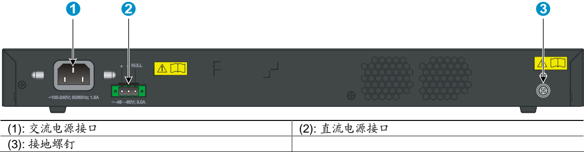
图1-14 S3600V2-28F-EI 后面板示意图
