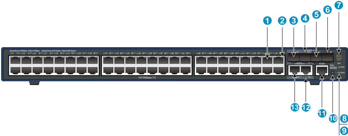
图1-7 S3600V2-52TP-SI 前面板示意图
