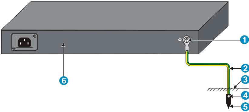
图3-10 机房附近允许埋设接地体时接地安装示意图
