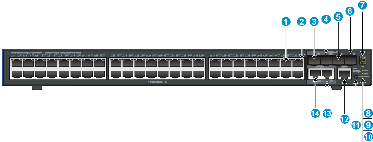
图1-5 S3600V2-52TP-EI 前面板示意图
