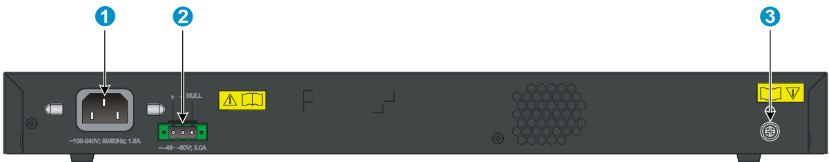
图1-2 S3600V2-28TP-EI 后面板示意图
