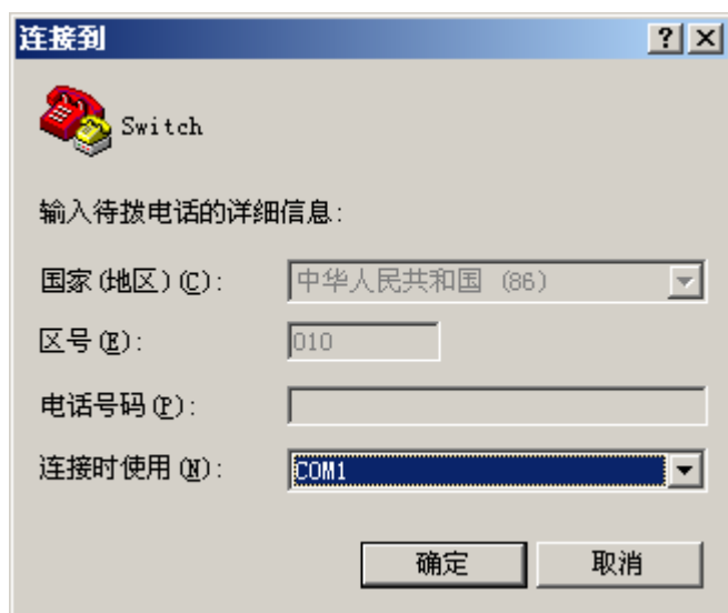
图4-4 超级终端连接使用串口设置
