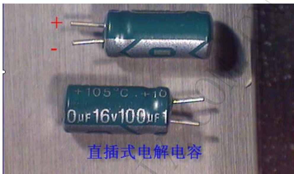
图 1-4 直插式电解电容的外表型式
