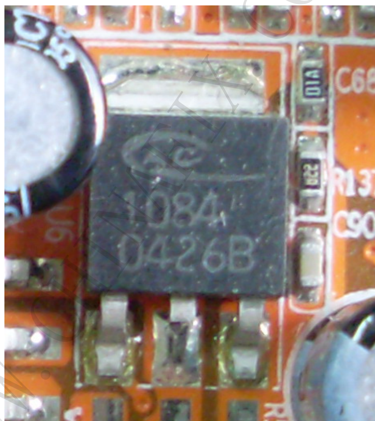
图 1-37 三端稳压器 1084 实物图
