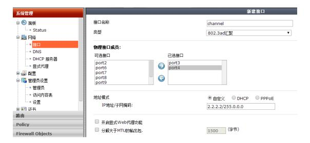
FortiGate 链路聚合需要两个或者两个以上,最大支持到八个接口,配置链路聚合的接口必须具备以下条件:
