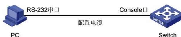
通过 Console 口配置 Telnet 登录方式的组网图
