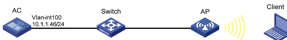
图2-10 PSK+Bypass 认证配置组网图
